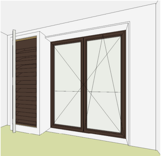
geluidswerend spuiventilatieluik (open) ter beeldvorming
