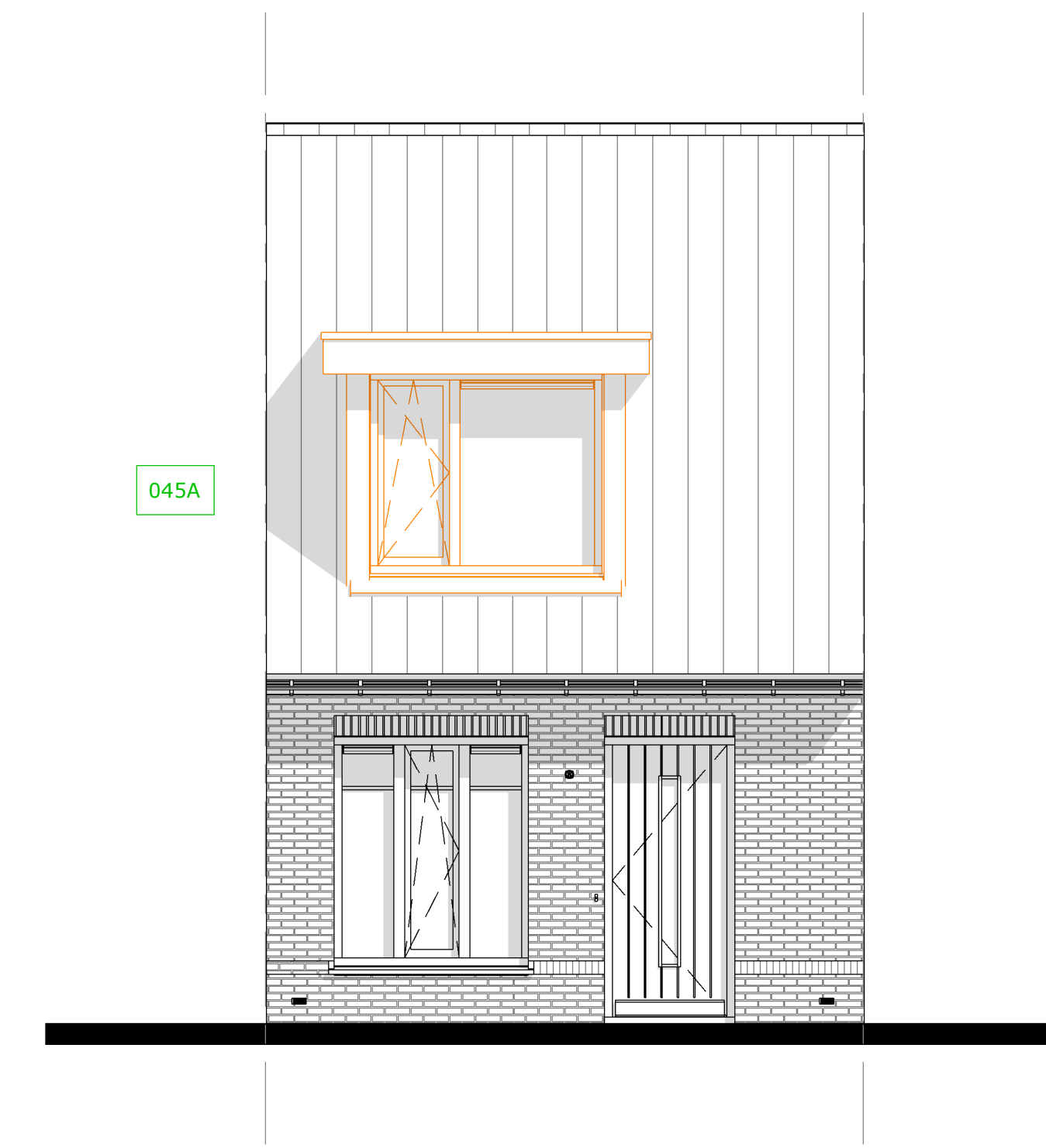
045A: dakkapel op achtergevel dakvlak (inwendige breedte 2000mm, vrije hoogte ca. 2600mm)
