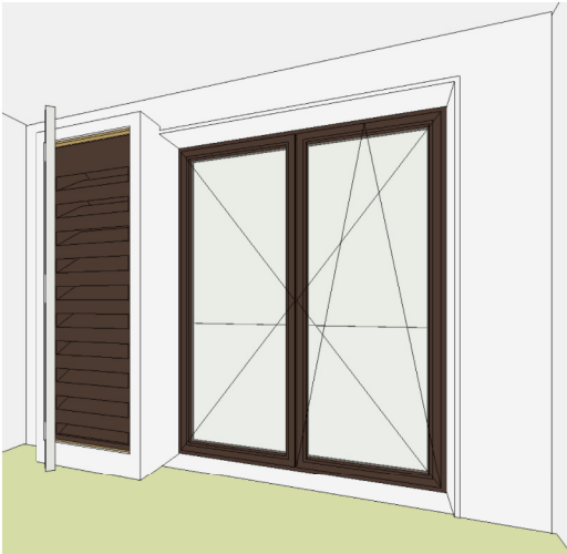
geluidswerend spuiventilatieluk (open) ter beeldvorming
